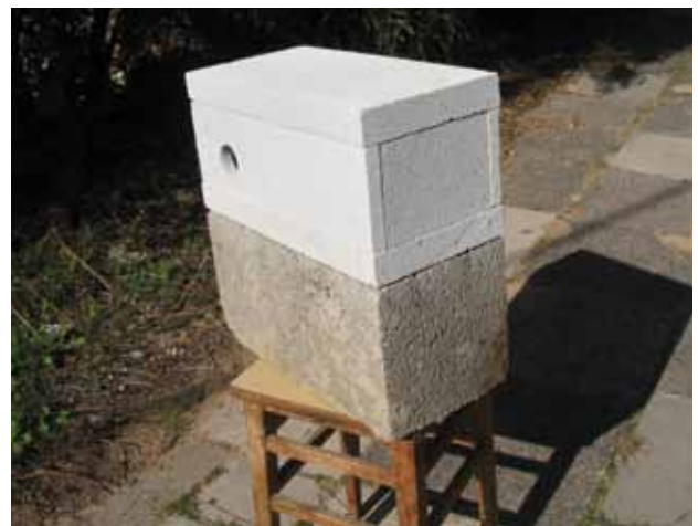
לבנה חלולה מאיטונג עם המידות 20x20x40 ס"מ כמידות בלוק בנייה רגיל. הצילום הוא על בלוק בניה סטנדרטי (צילום: אמנון האן)
